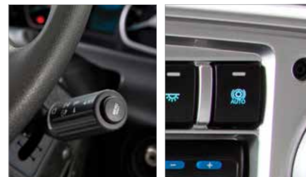
Ovládacia páčka motorovej brzdy a intardéra: pomocné brzdy môžete aktivovať manuálne alebo môžete povoliť vozidlu, aby ich za vás nastavilo automaticky.
