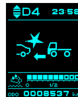
Vizuálna výstraha AEBS na prístrojovom displeji
